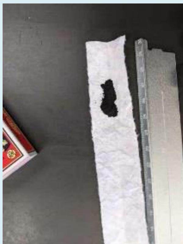
自作の線香花火は、火薬が燃焼するよりも先に半紙が燃焼したため、燃焼時間は短かったが、市販の線香花火は一端に集中して置かれているので、火薬がしっかりと燃焼されることにより燃焼時間が伸びたと考えられる。
